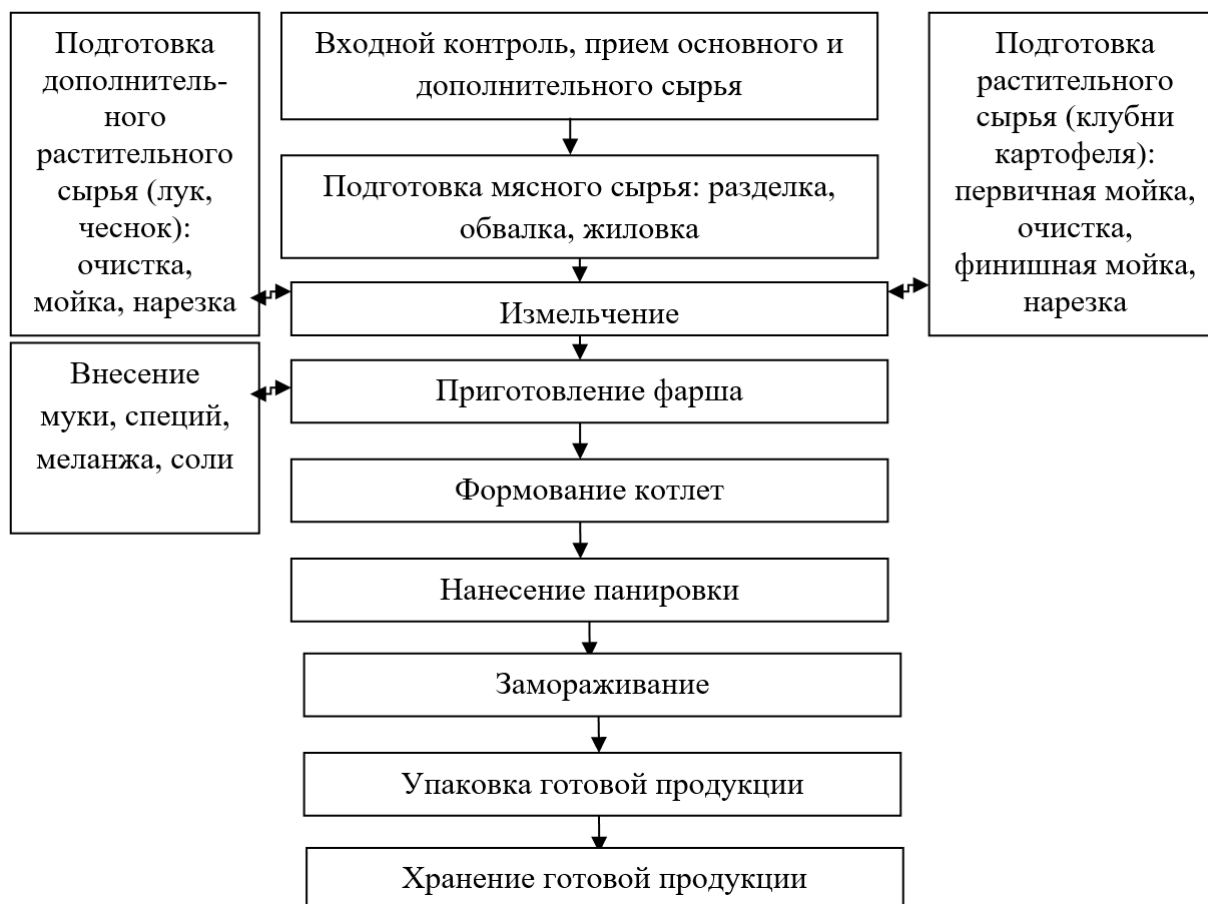
Рис. 1. Технологическая схема производства рубленых котлет с добавлением растительного сырья
